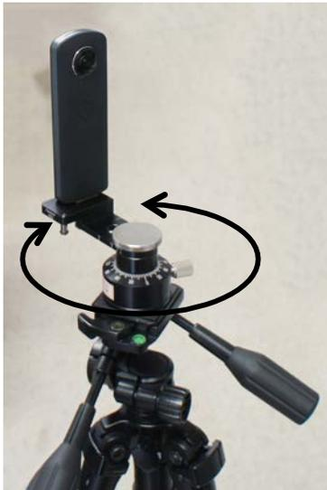
図 4 360° カメラを回転させるためのジグ
